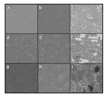
Figure 3: SEM surface morphology of (a) LI<sup>\*</sup>; (b) LI- V5 (c) LI-UV5 (d) BD (e) BD-V5 (f) BD-UV5 (g) BT (h) BT – V5 (i) BT-UV5
