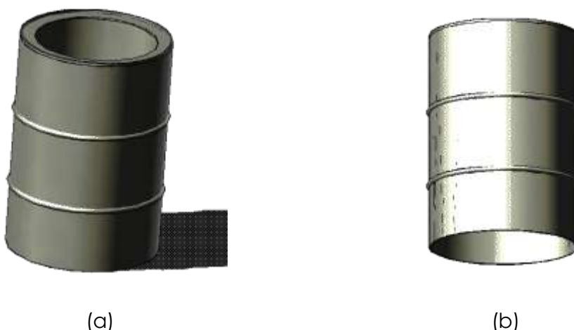
Figura 1 – Detalhe do reator para carbonização: (a) Detalhe superior, e; (b) detalhe do fundo do tambor.
