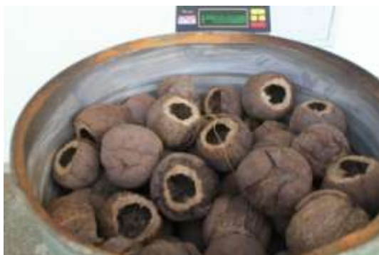
Figura 2 – Pesagem e abastecimento do reator.
