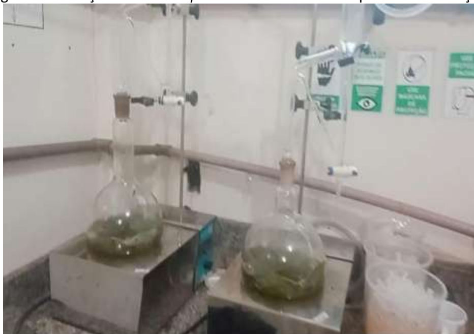
Figura 2 - Extração de OE de Piper aff. divaricatum feito por hidrodestilação.
