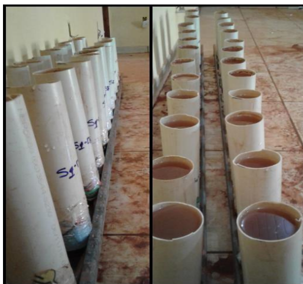
Figura 1. Imagem dos tratamentos em tubos de PVC após pluviosidade diária simulada (100 mm).
