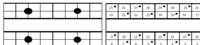
Figura 2 - a) Representação dos sensores para aferição de temperatura ambiente; b) Representação dos sensores de globo negro nas baias selecionadas
