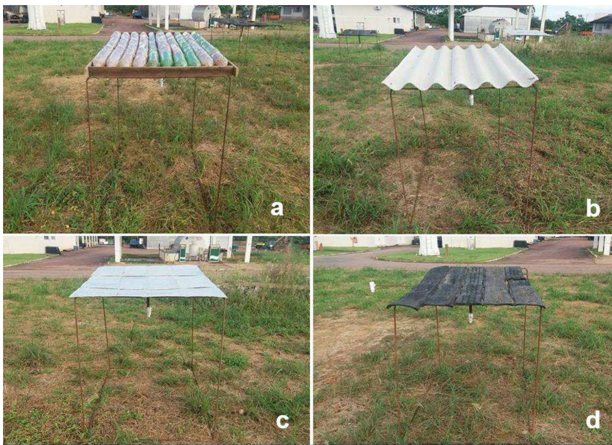
Figura 1 - Modelos de abrigos móveis com diferentes materiais para cobertura: a) Garrafa PET preenchida com maravalha; b) Telha tipo Eternit®; c) Embalagens Tetrapack® compactadas e d) Bandas de rodagem de pneus.
