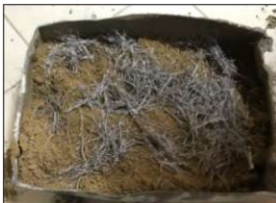
Figura 4 - Adição da fibra na mistura para fabricação do concreto
