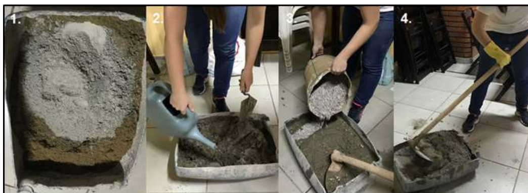
Figura 3. Etapas da mistura para fabricação do concreto convencional
