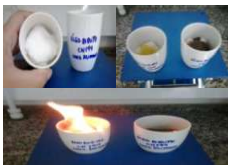
Figura 4 - Teste de combustão realizado com o biodiesel de soja e óleo bruto
