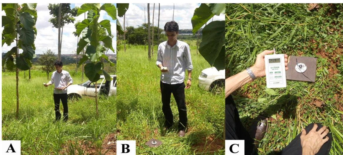
Figura 1. Determinação da incidência de radiação a 1,5 m do solo (A) e ao nível do solo (B) utilizando sensores de radiação fotossinteticamente ativa (C), Goiânia, GO, 2015.
